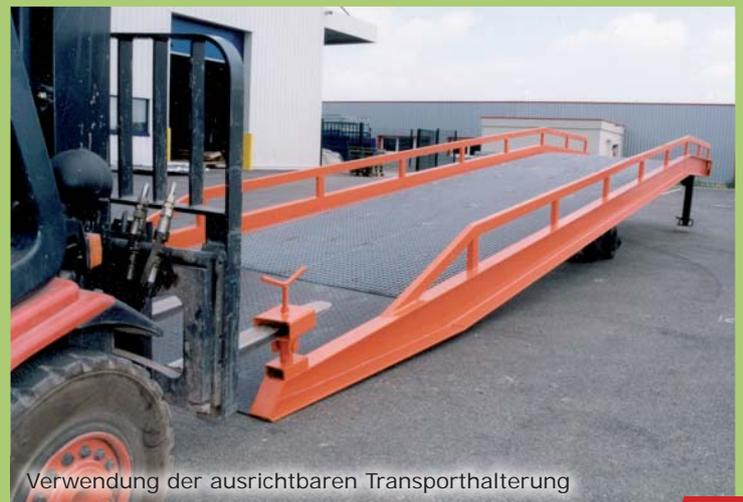
Verwendung der ausrichtbaren Transporthalterung
