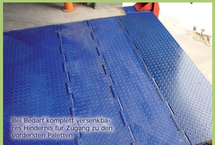
Bei Bedarf komplett versenkbares Hindernis für Zugang zu den vordersten Paletten
