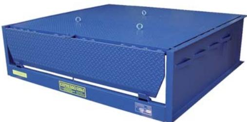
Die Anpassrampe ist auf 3 Seiten von einem Kasten mit Betonankern umgeben. Die Anpassrampe wird auf eine Bodenplatte mit auf 3 Seiten vorgesehenen Bewehrungsstäben aufgesetzt; die Bewehrungsstäbe werden mit den Betonankern verschweißt und dann vergossen.
