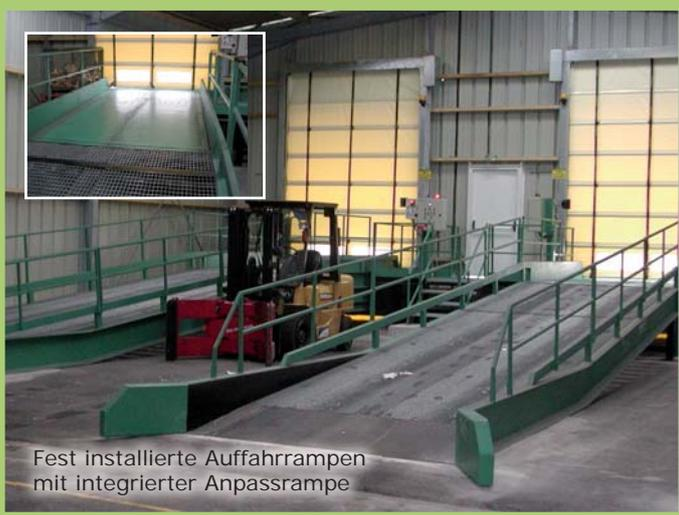
Fest installierte Auffahrampen mit integrierter Anpassrampe
