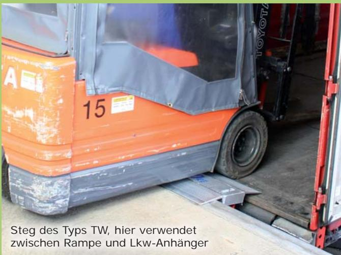
Steg des Typs TW, hier verwendet zwischen Rampe und Lkw-Anhänger
