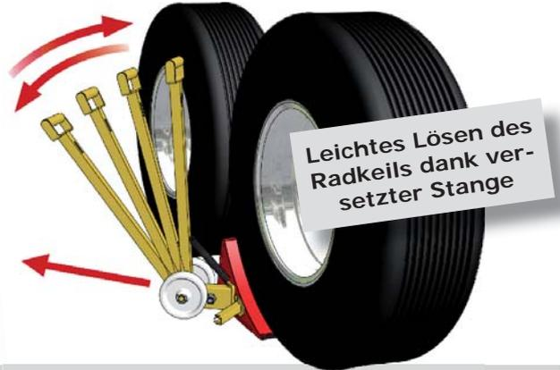
Leichtes Lösen des Radkeils dank versetzter Stange
