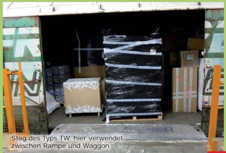
Steg des Typs TW, hier verwendet zwischen Rampe und Waggon
