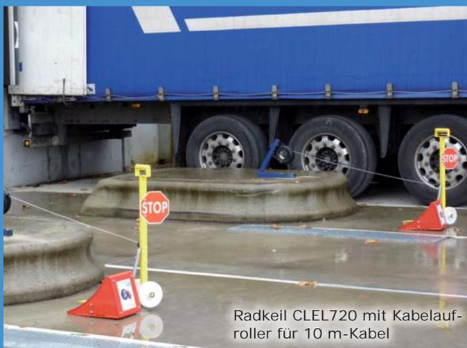
Radkeil CLEL720 mit Kabelaufroller für 10 m-Kabel
