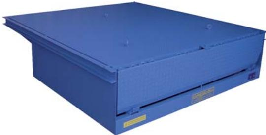
Die Anpassrampe verfügt an ihrer Oberseite über einen umlaufenden Rahmen (mit Betonankern auf 3 Seiten), der in die hierfür vorgesehene Fuge in der Grube eingelassen wird. Die Betonanker werden mit den Bewehrungsstäben verschweißt und später bis auf Höhe des Bodenbelags vergossen.
