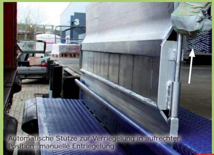
Automatische Stütze zur Verriegelung in aufrechter Position: manuelle Entriegelung
