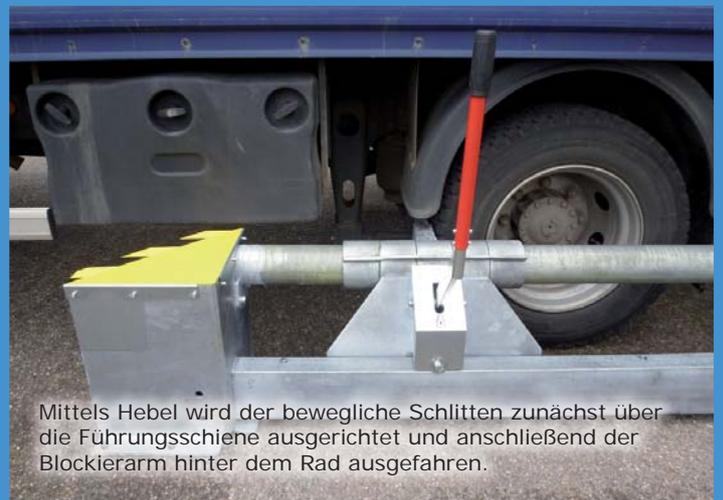
Mittels Hebel wird der bewegliche Schlitten zunächst über die Führungsschiene ausgerichtet und anschließend der Blockierarm hinter dem Rad ausgefahren.
