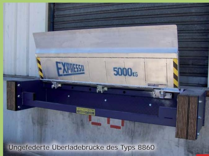
Ungefederte Überladebrücke des Typs 8860
