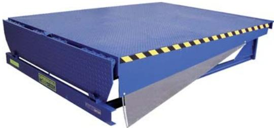
Die Anpassrampe verfügt auf ihrer Rückseite über eine Leiste, die mit der Grubenleiste verschweißt wird. Die Querstrebe auf der Vorderseite wird mit den vertikalen Leisten der Grube verschweißt.
